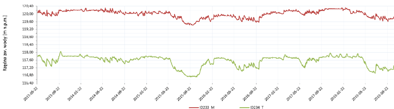
Rys. 5.8 Hydrogram stanów wody w lokalizacji „Jastrzębna” (ID233_M, ID234_T). Braki danych wynikają z okresowych błędnych odczytów stanów wody
