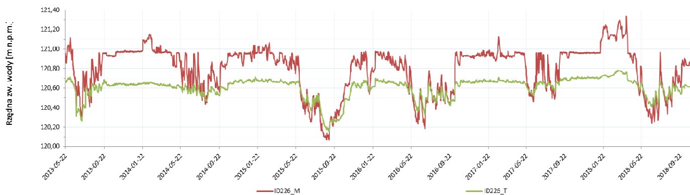
Rys. 5.6 Hydrogram stanów wody w lokalizacji „Kamienna-Kropiwno” (ID226_M, ID226_T). Braki danych wynikają z okresowych błędnych odczytów stanów wody
