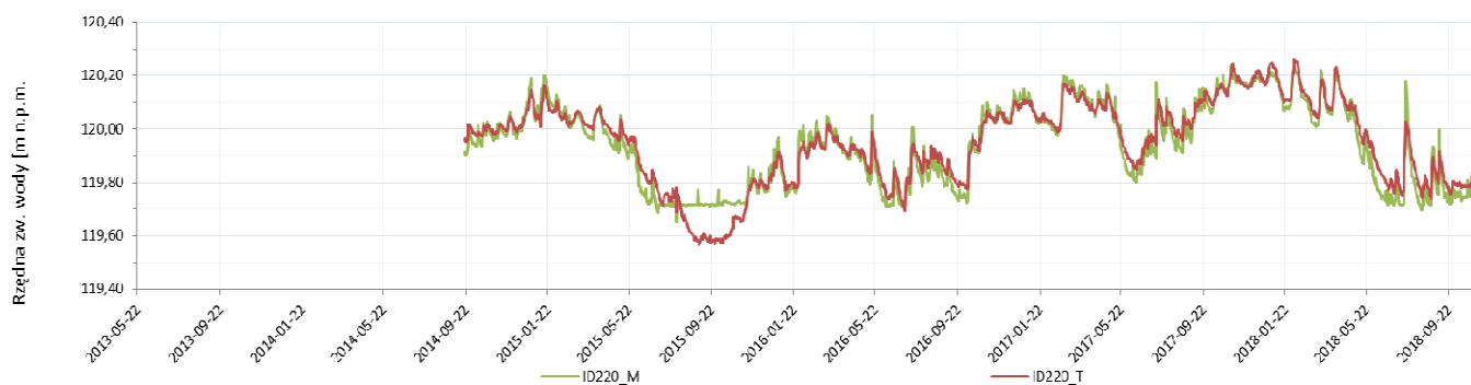
Rys. 5.3 Hydrogram stanów wody w lokalizacji „Lojstry” (ID220_M, ID220_T). Braki danych wynikają z instalacji piezometrów w późniejszym terminie.
