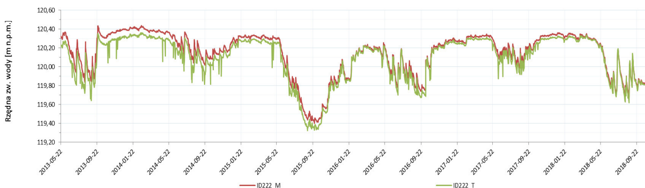
Rys. 5.2 Hydrogram stanów wody w lokalizacji „Rogożynek” (ID222_M, ID222_T). Braki danych wynikają z okresowych błędnych odczytów stanów wody
