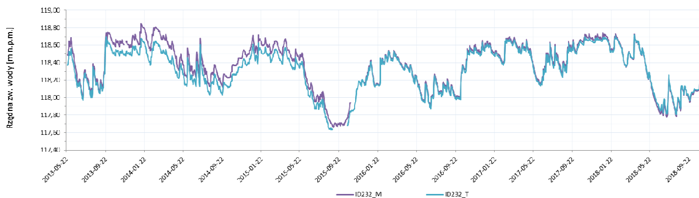
Rys. 5.7 Hydrogram stanów wody w lokalizacji „Ostrowie” (ID232_M, ID232_T). Braki danych wynikają z okresowych błędnych odczytów stanów wody
